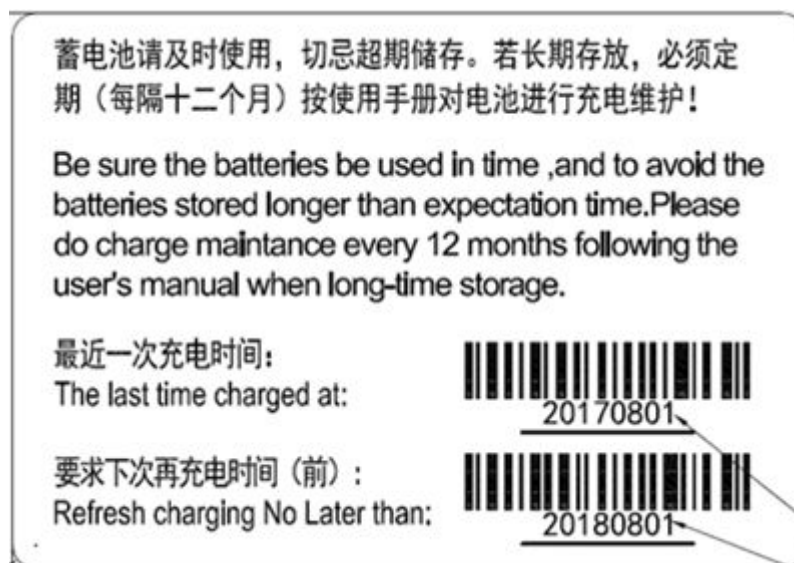
図 5-1 蓄電池充電ラベル
